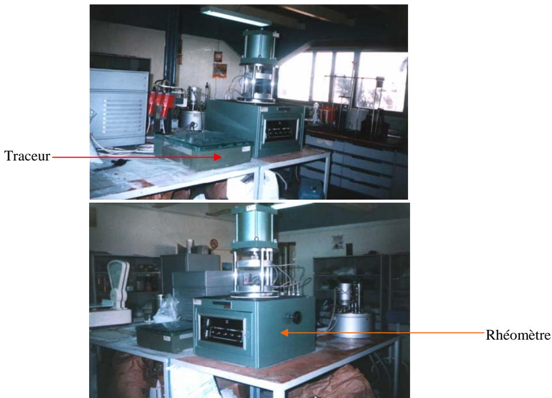
Fig. III.3 : Rhéomètre de type MONSANTO.
